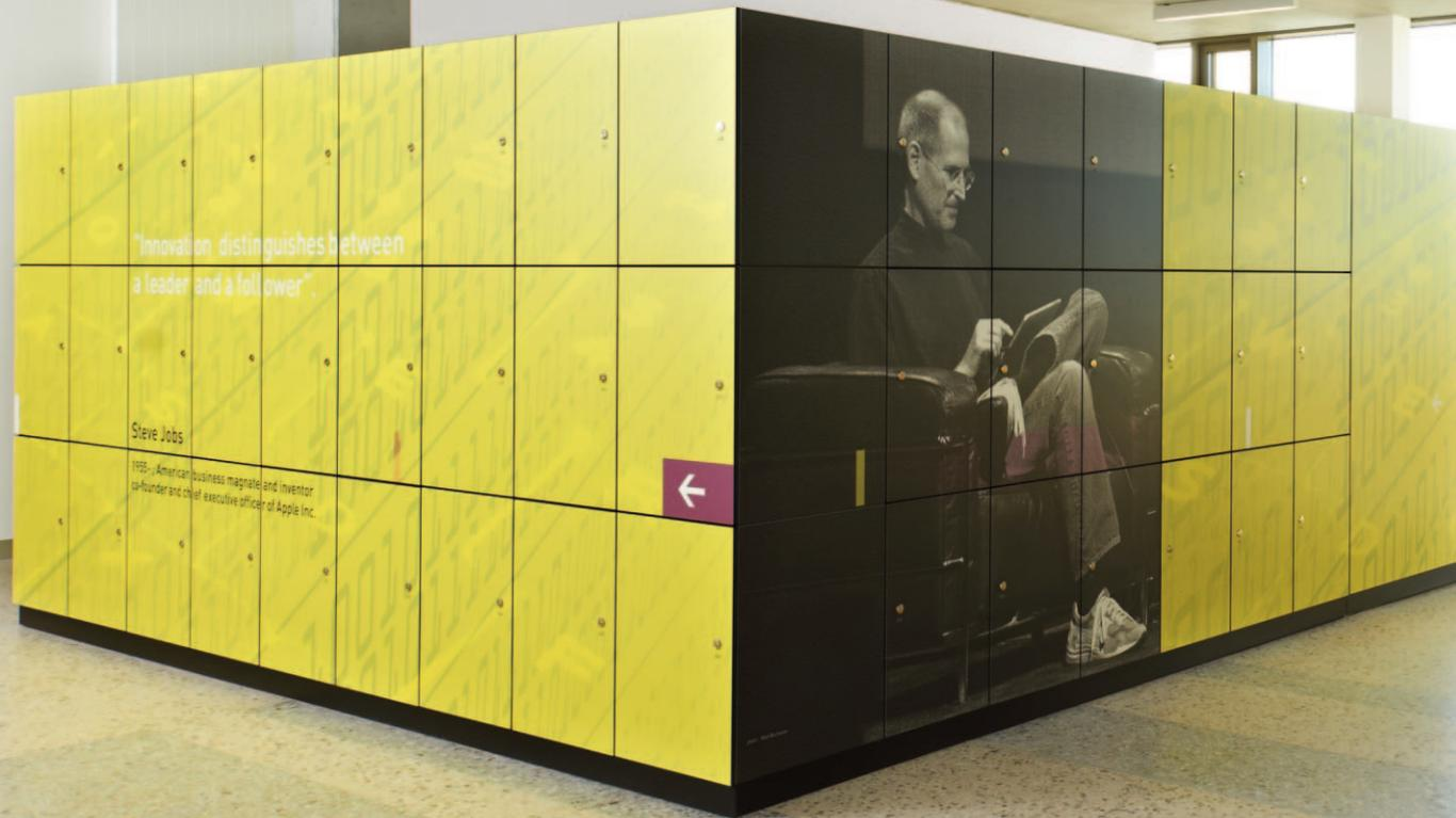
Kundenindividuelle Motivdrucke ermöglichen einzigartige Themenkonzepte. Das Motiv wird bereits bei der Herstellung des HPL-Plattenmaterials mit in die Platte eingepresst. So entsteht eine robuste und dauerhafte Oberfläche.
