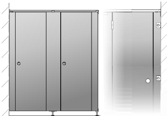
2 Vista planimetrica frontale con porta con cerniera fino a 180° (staffe di fissaggio in alluminio all'interno della cabina)
