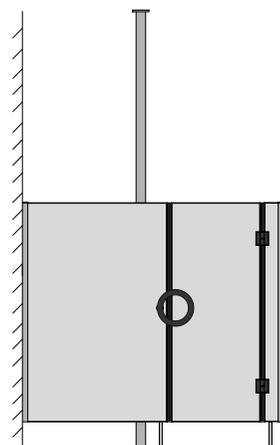
Per stabilizzare le parti frontali larghe può essere necessario inserire un tubo in alluminio da pavimento a soffitto.
