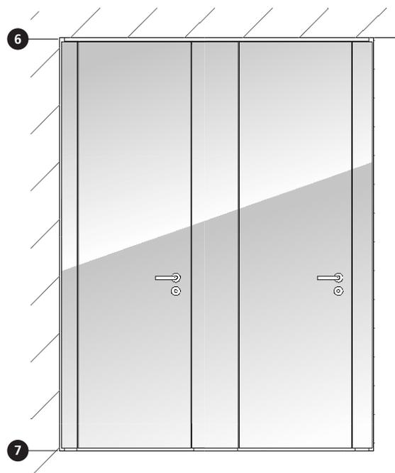
2 Sezione frontale della cabina con coppia di maniglie a leva
